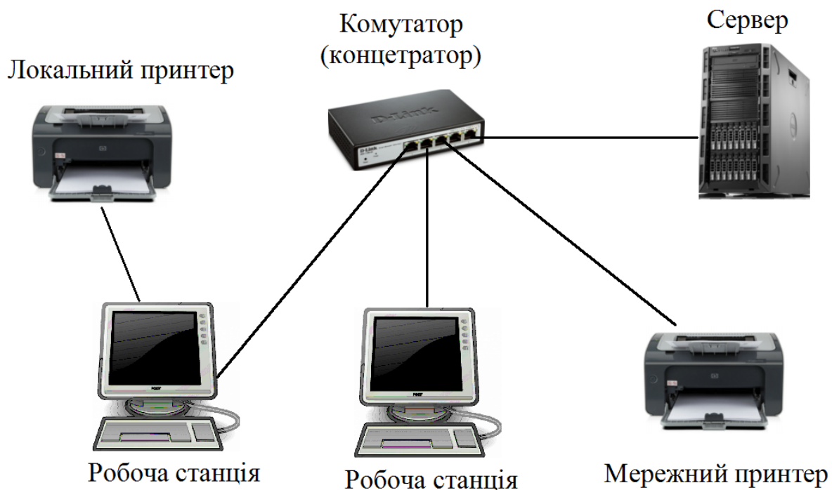
Рис.1.12. Структурна схема локальної мережі на основі сервера.
