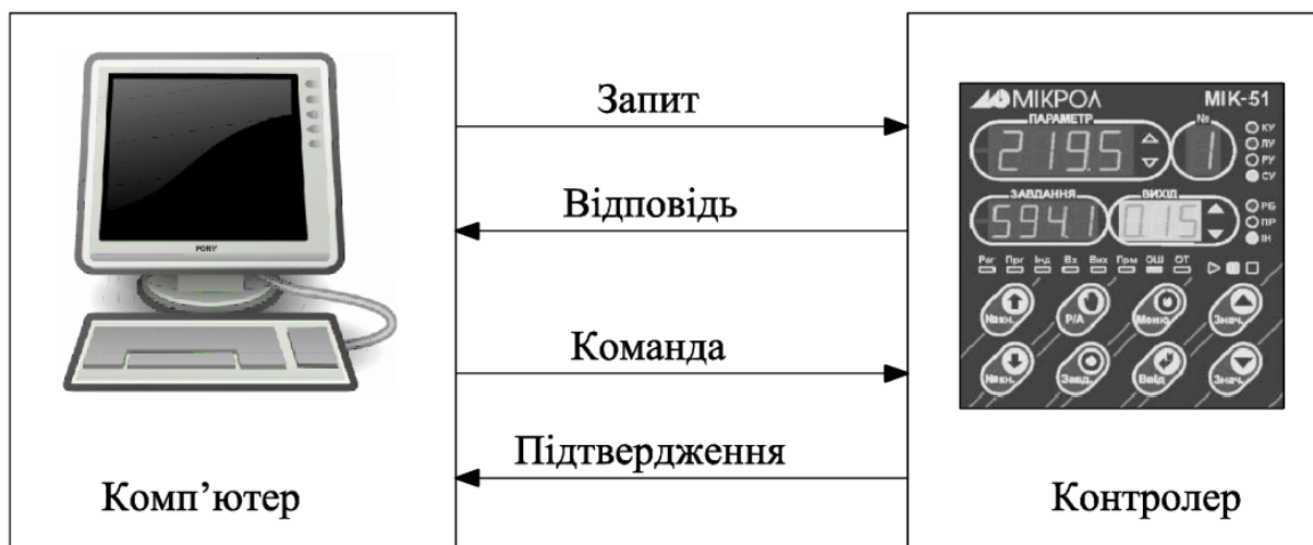
Рис.4.126. Схема взаємодії повідомлень у разі зв'язку PLC з PC.
