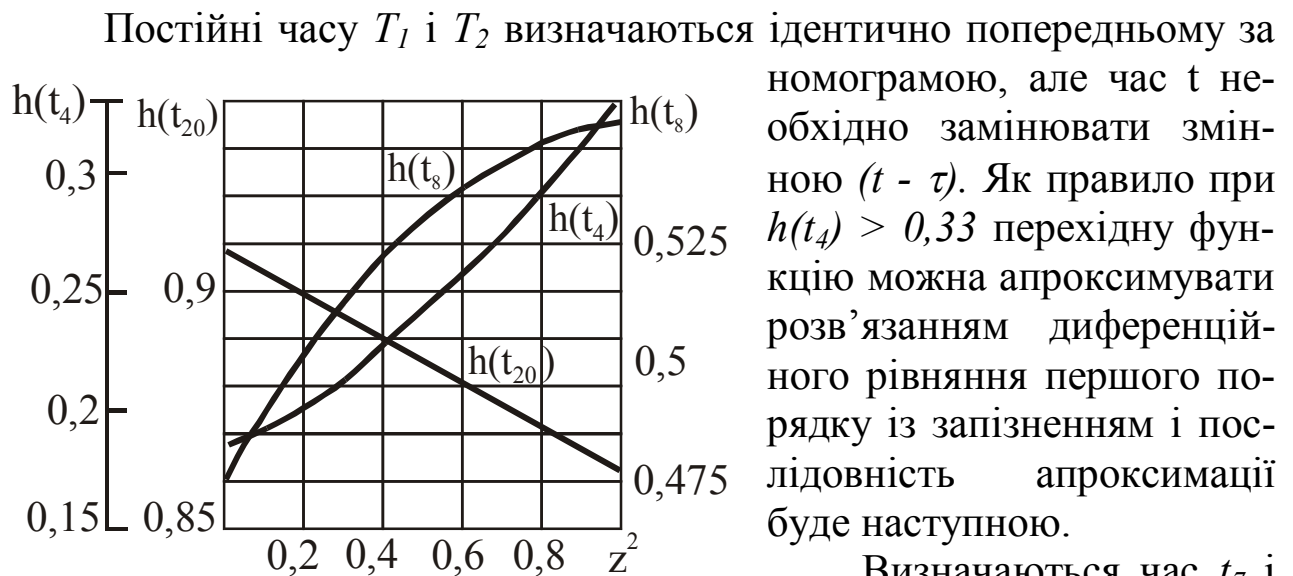
Рис. 3.17. Номограма для визначення коефіцієнтів диференційного рівняння інтерполяційним методом Ормана.
