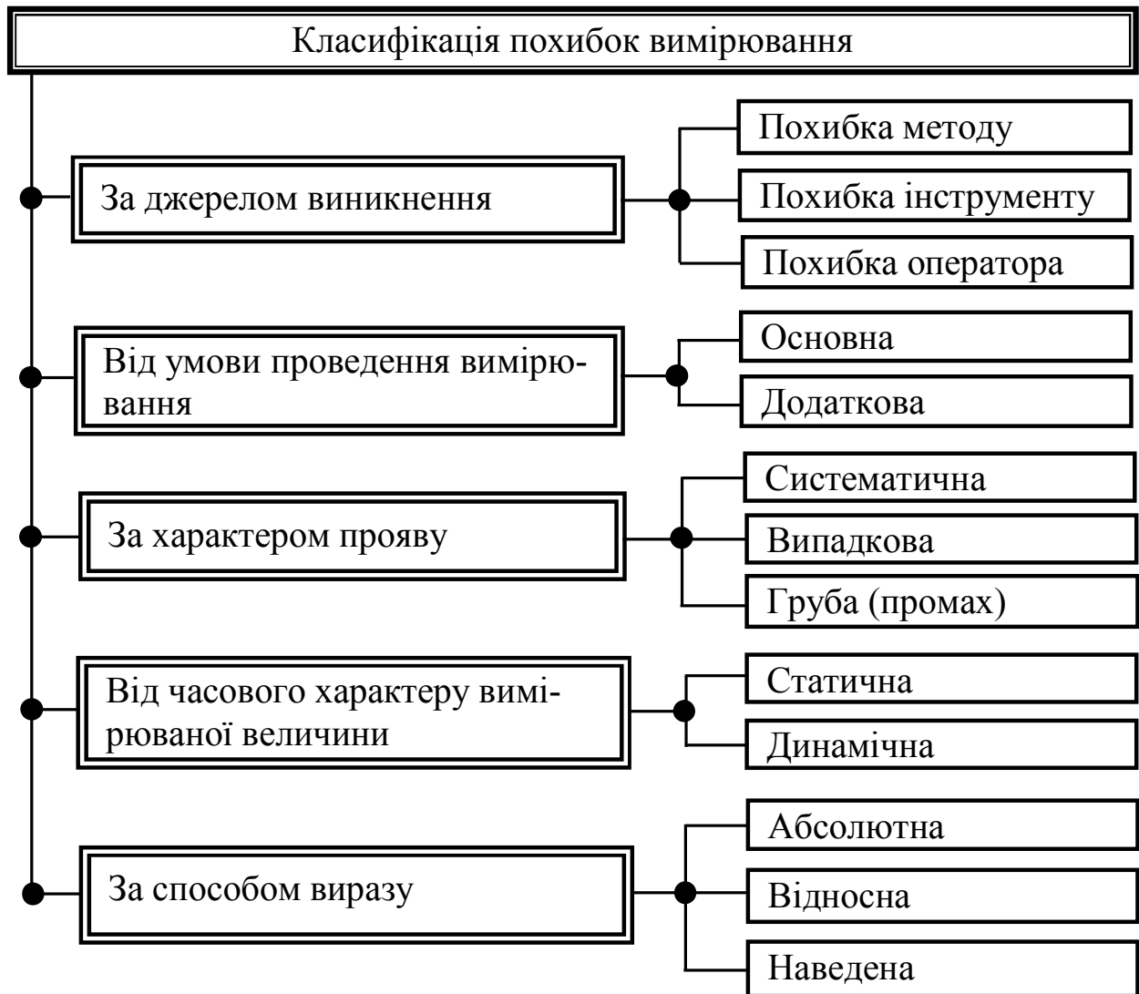
Рис. 1.2. Узагальнююча схема класифікації похибок.
