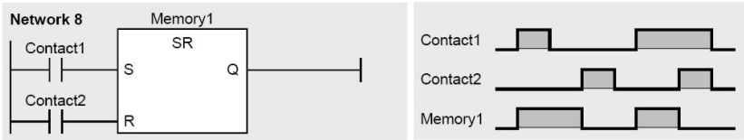
Рис. 1.37. Ланцюг з блоком з пріоритетом скидання та діаграма стану операнду пам'яті
