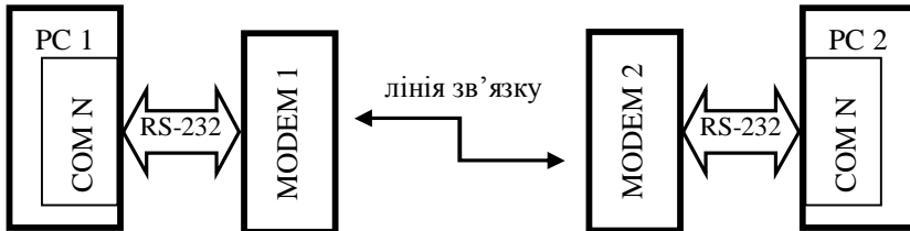
Рисунок 2.3 – Схема з’єднання двох комп’ютерів з використанням модемів
