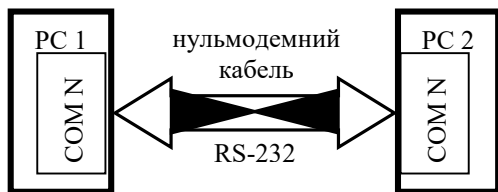
Рисунок 1.1 – Схема лабораторного комплексу (схема з'єднання двох ПК без модема)
