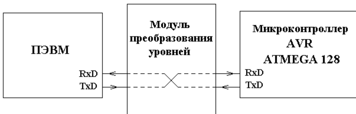
Рисунок 3.10. – Обобщенная функционально-структурная схема соединения двух устройств с помощью интерфейса RS-232C
