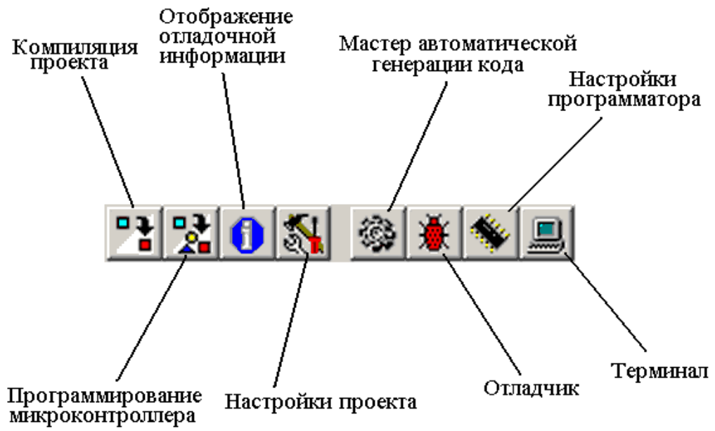
Рис. 2.5. – Назначения pictogramм, отвечающих за выполнение специализированных функций
