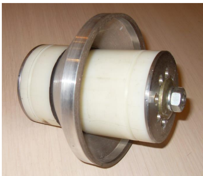
Рис. 5.2. Алмазный шлифовальный круг в сборе со специальной оснасткой перед локальной электроизоляционной модернизацией по методу МДО
