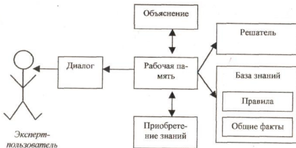
Рисунок 1.40 – Схема обобщенной экспертной системы
