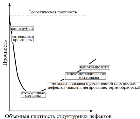
Рисунок 1.17 – Схематическая зависимость прочности от плотности атомарных дефектов в материале
