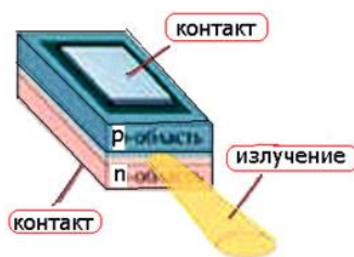
Рисунок 6 – Схема формирования излучения диодного лазера
