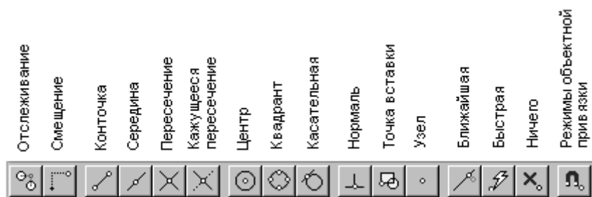
Рис. 4. Панель Объектная привязка
