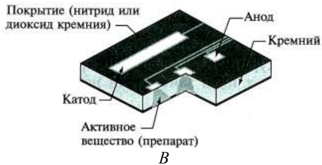
Рисунок 8.13 – Принцип работы и основные функции биодатчика ( a ), «лаборатории на чипе» ( б ); биочип ( в )
