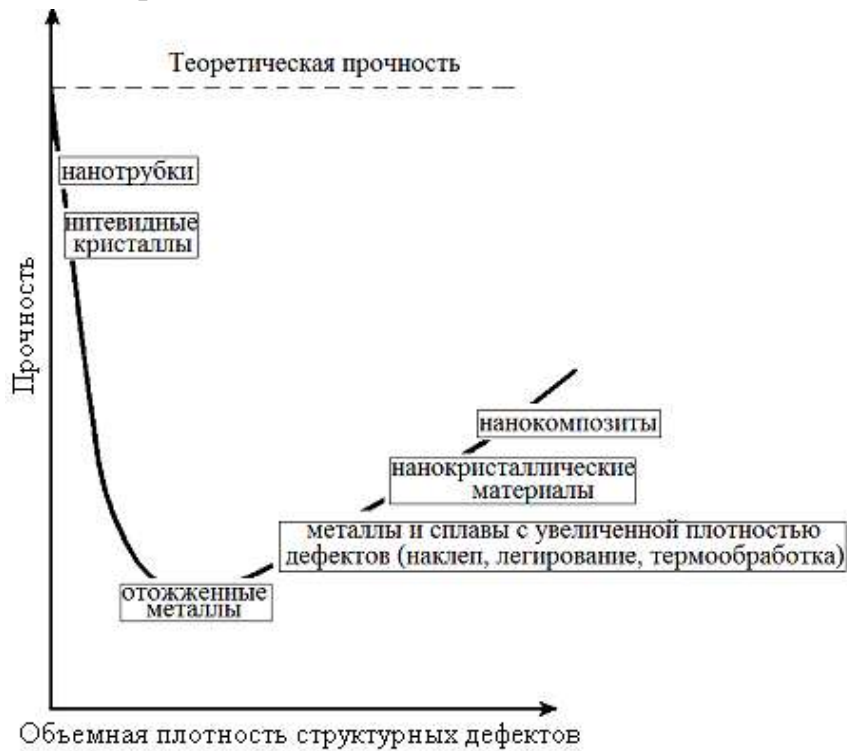
Рисунок 4.8 – Схематическая зависимость прочности от плотности атомарных дефектов в материале
