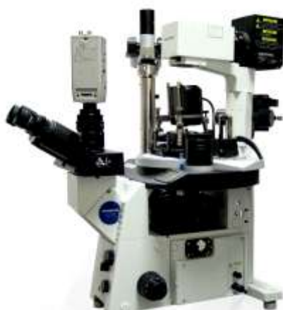
Рисунок 2.10 – Принцип работы СОМБП (а) и общий вид (б) сканирующего оптического микроскопа ближнего поля:
