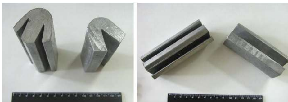
Рисунок 8.2 – Примеры изделий, полученных сверхпластической точной объемной штамповкой на основе реализации сверхпластичности алюминия и его сплавов: а – изделие типа «поршень»; б – токосъемники для электротранспорта с высокой износостойкостью
