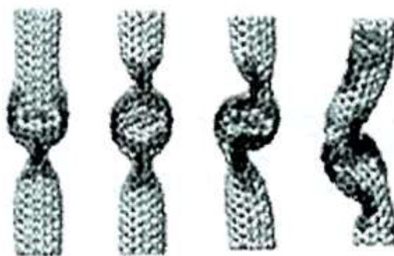
Рисунок 6.17 – Поведение углеродных нанотрубок при деформации
