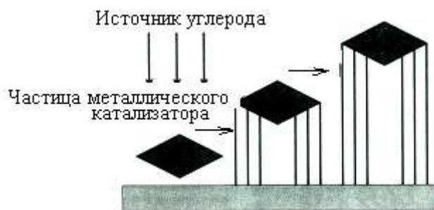
Рисунок 6.15 – Схема установки для получения нанотрубок методом химического осаждения из пара при пиролизе углеводорода (a) и механизм роста углеродных нанотрубок (б)
