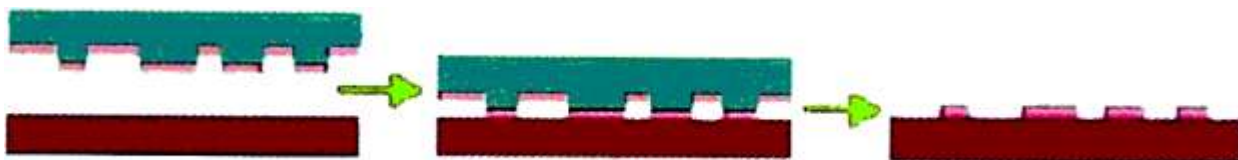
Рисунок 3.17 – Схема процесса переноса изображения методом литографии
