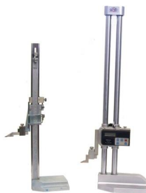
Рисунок 3 – Штангенрейсмус с отсчетом по нониусу и с цифровой шкалой
