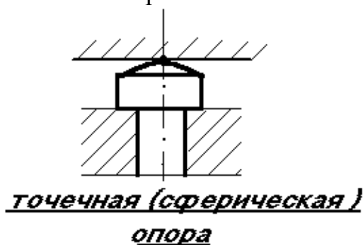
Рис. 14. Реализация точечного контакта Рис. 15. Базирование по плоскости
