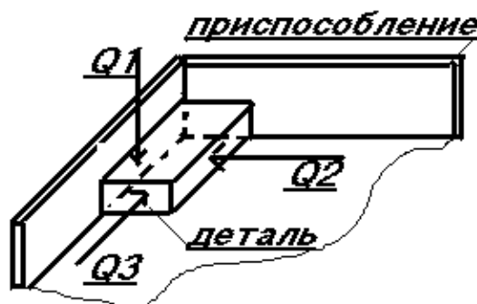
Рис. 14. Реализация точечного контакта Рис. 15. Базирование по плоскости
