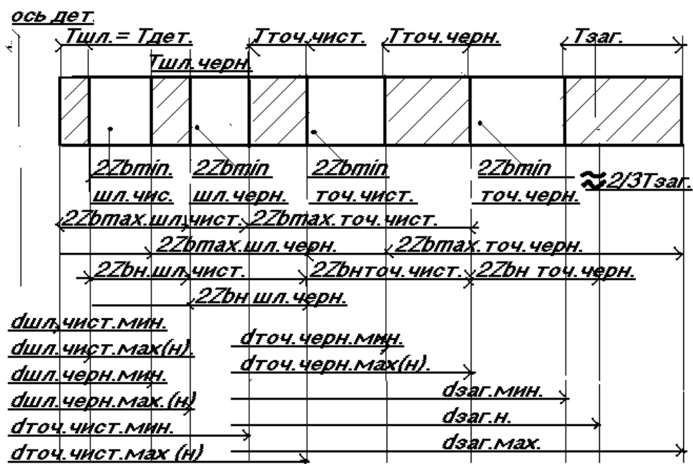
Рис. 40. Схема расположения припусков при обработке вала.
