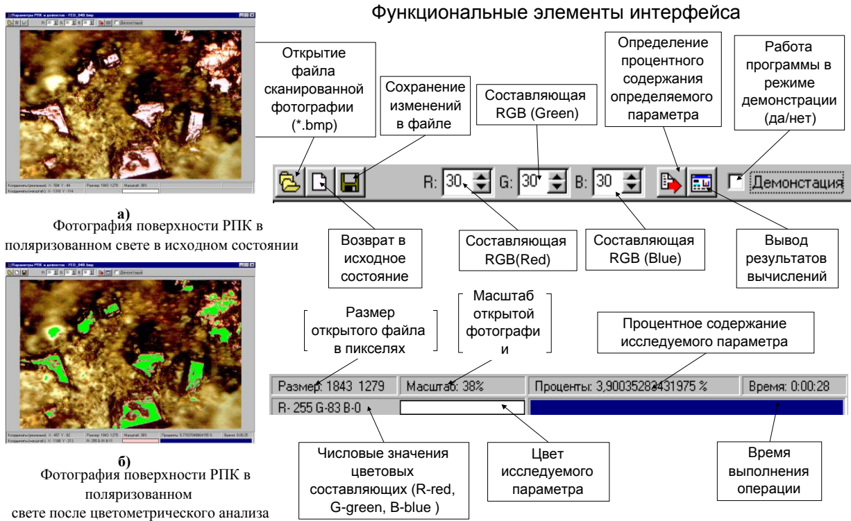
Рисунок 1- Компьютерная цветиметрическая методика изучения параметров рабочей поверхности алмазного круга
