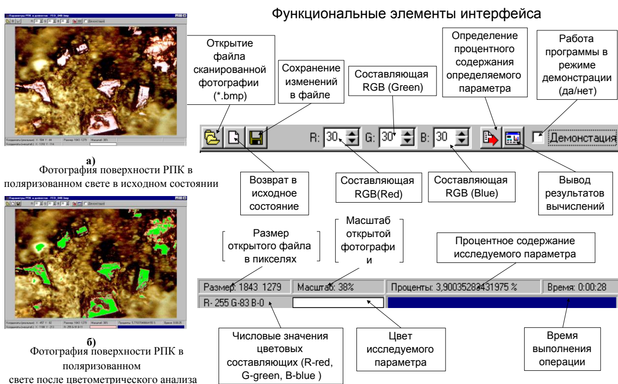
Рисунок 1- Компьютерная цветометрическая методика изучения параметров рабочей поверхности алмазного круга
