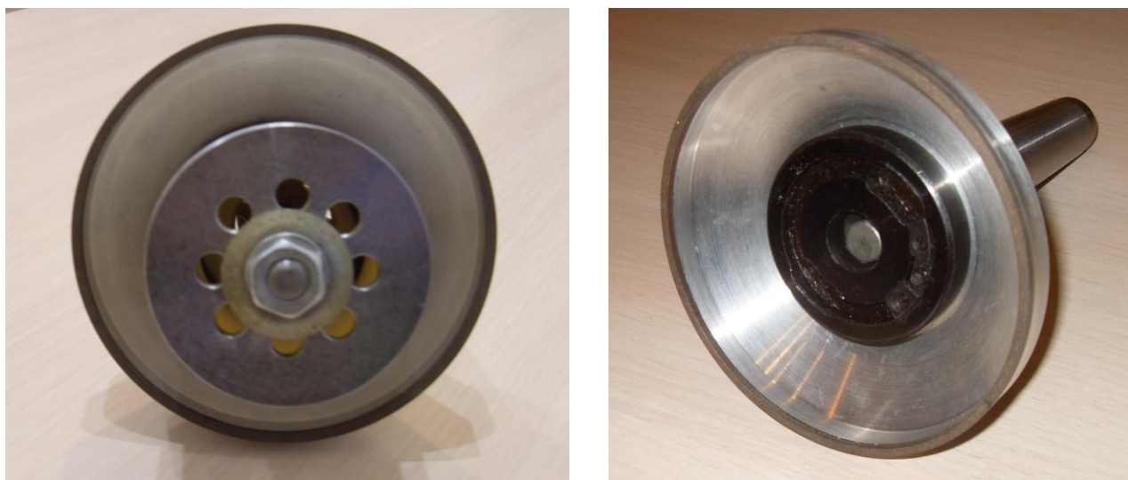
а а) на специальной оправке после локальной МДО; б) б) на шпиндельной оправке шлифовального станка
