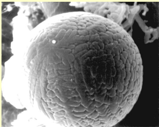
Сферическая частица из продуктов взаимодействия, отобранная из окружающей среды
