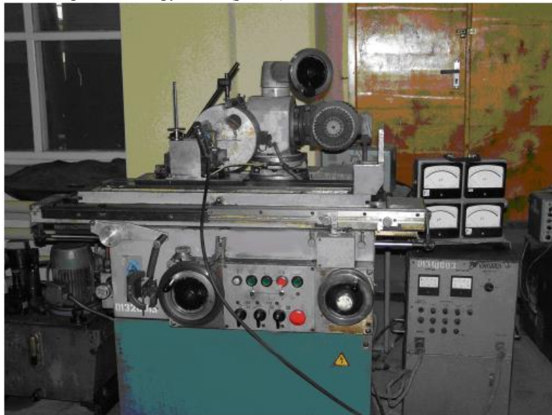
Рис. 1 – Модернізований універсально-заточний верстат мод. ЗД642Е
