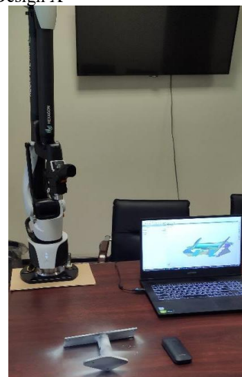
Рис. 4– Процес сканування кронштейну
