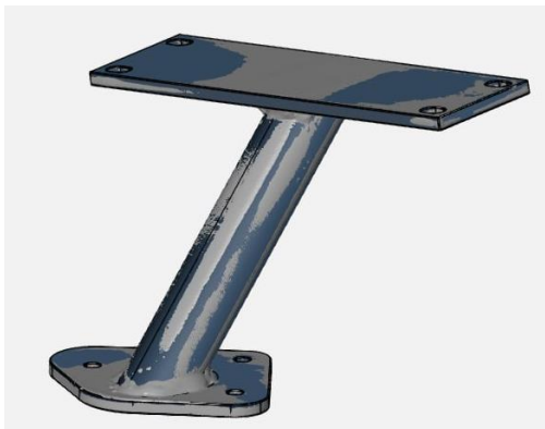
Рис.7 – Вирівняні stl-моделі щодо CAD-моделей за допомогою функції best-fit
