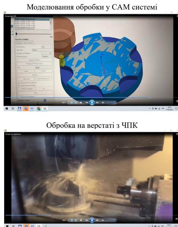
Рис. 11– Послідовність створення відновленої копії зношеної деталі
