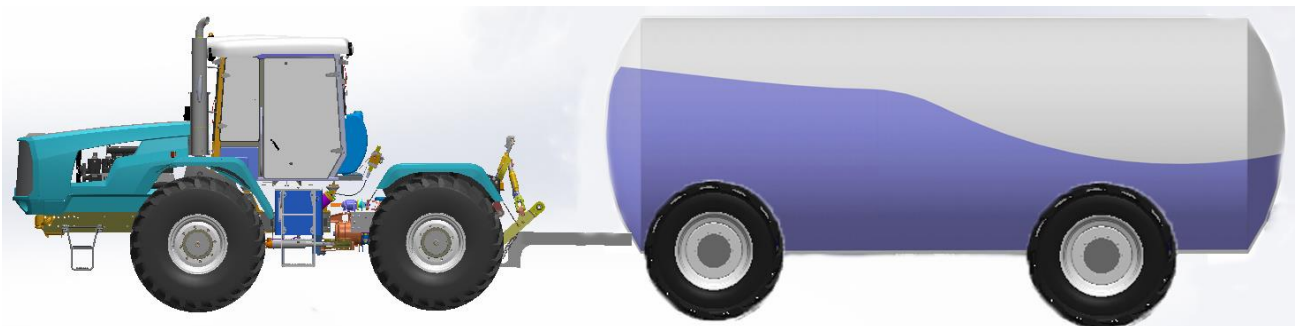
Рис. 1 – Імітація руху рідини в цистерні сільськогосподарського призначення на етапі розгону машинно-тракторного агрегату
