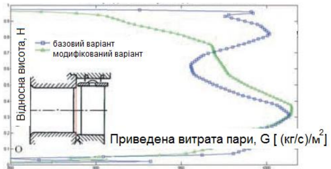
Рис. 3.4. Вплив геометричних змін на деякі характеристики потоку в турбінному ступені:
