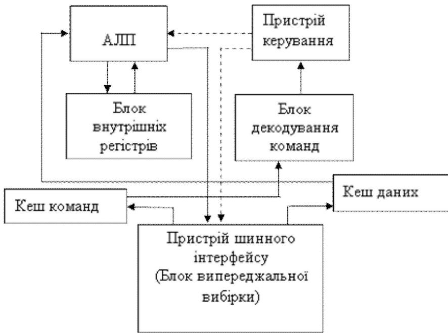
**Рис. 1.2.** Спрощена схема універсального мікропроцесора
