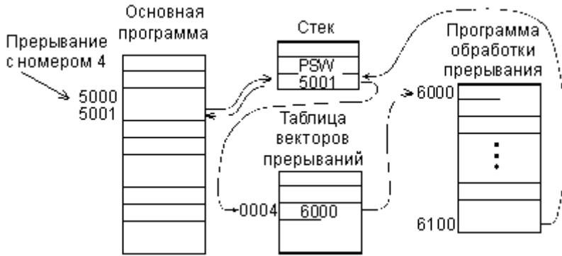
**Рис. 7.3.** Спрощений алгоритм обробки переривання.
