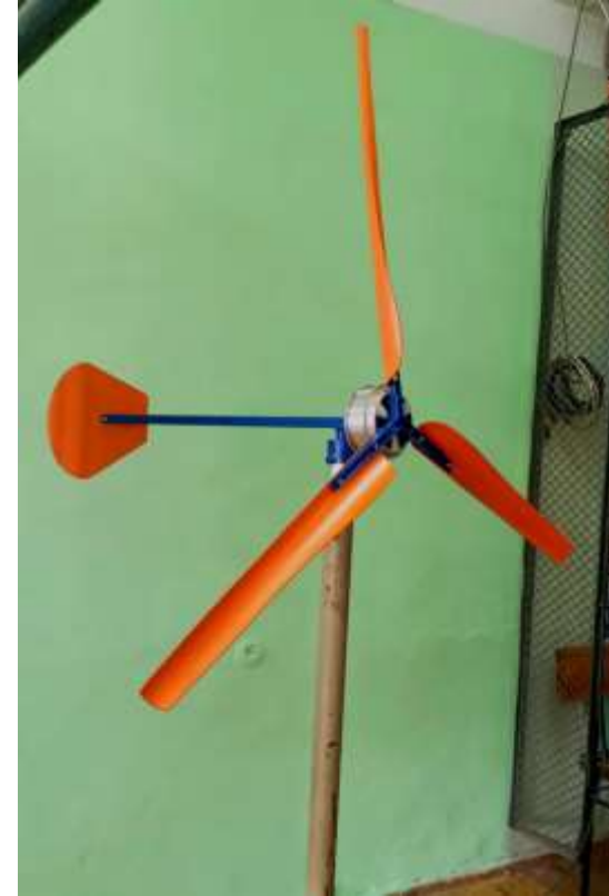
Вітроустановка для вивчення потужності міні-вітрогенераторів.
