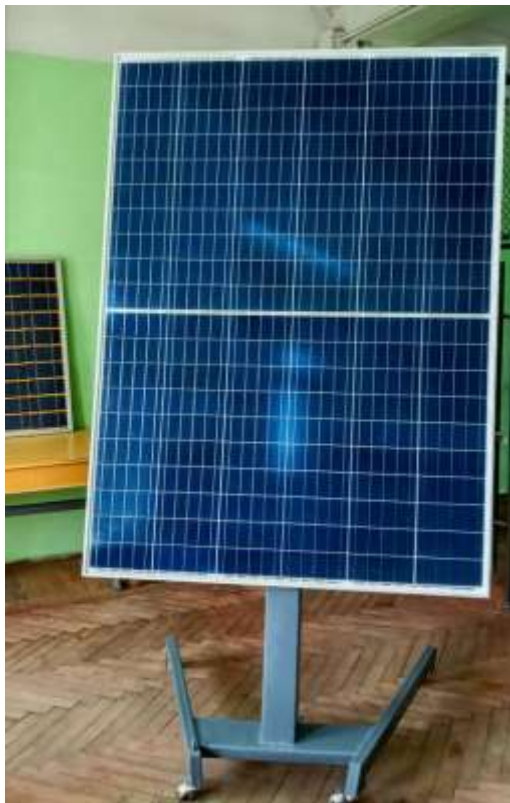
Дослідження енергетичних характеристик полікристалічної фотопанелі.
