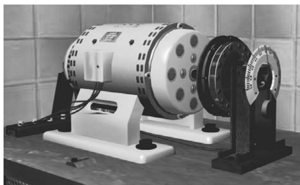
Рис. 6. Виртуальный ДПТ с электромагнитным тормозом
