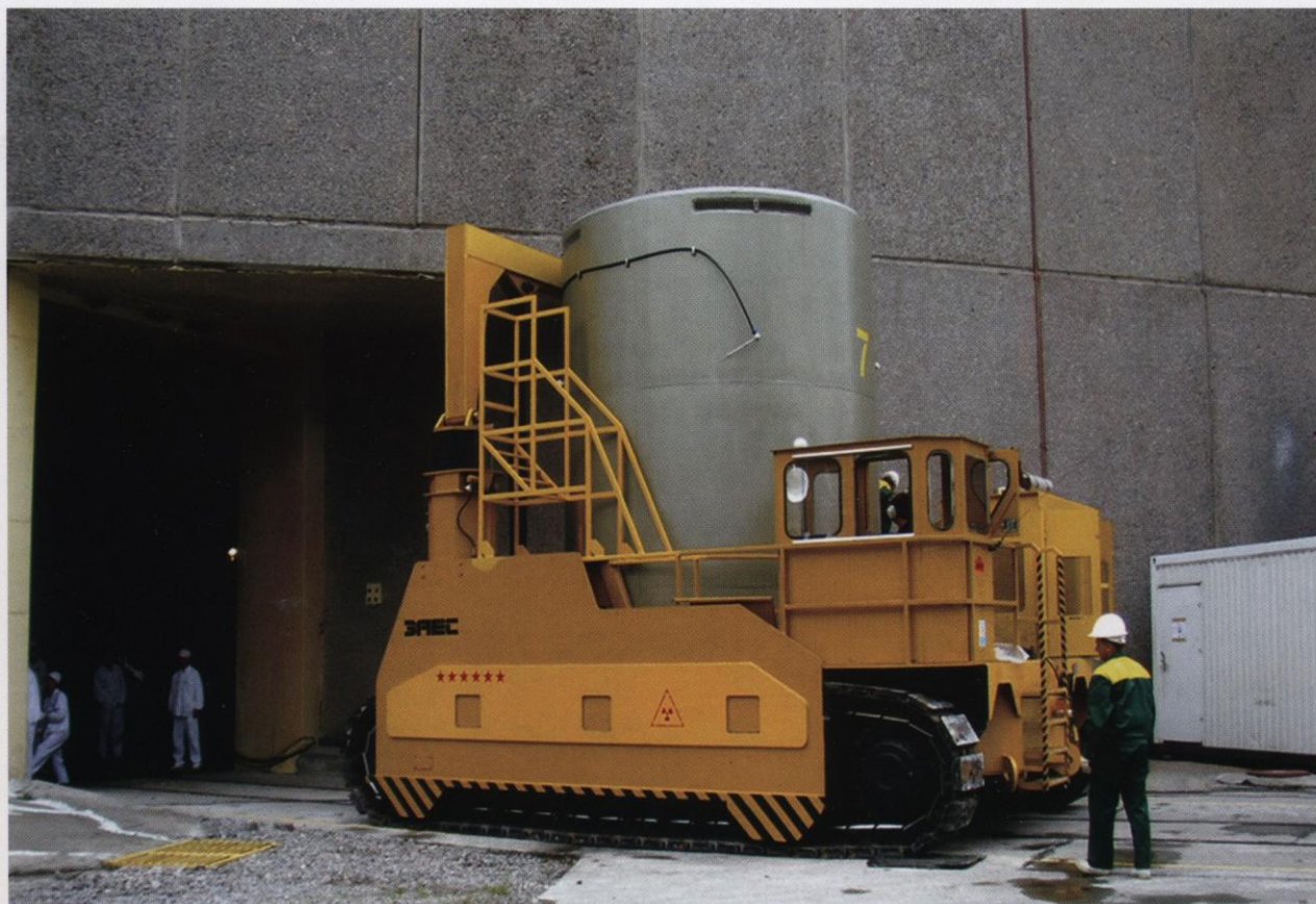
Рис. 1. Контейнер СХОЯТ, установленный на транспортере
