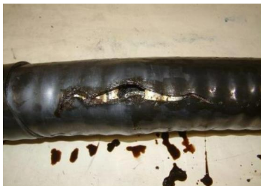
Рисунок 7.4 – Наскрізний пробій ізоляційного шару внаслідок дії часткових розрядів
