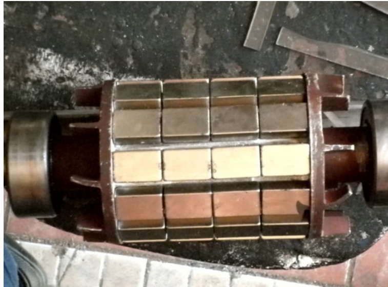
Рисунок 5 – Зразок переробленого ротора асинхронної машини. Вказано розміщення 32 постійних магнітів-пластин на роторі
