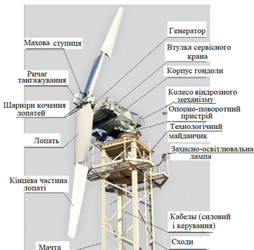
Рисунок 1 – Варіант комплектування ВЕУ відносно невеликої потужності (20-50 кВт)
