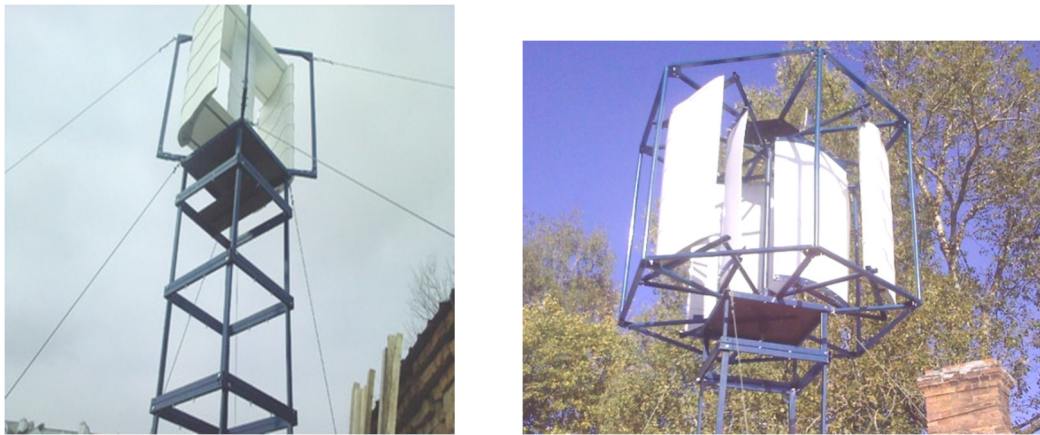
Рисунок 7 – Серійна одноярусна роторна установка потужністю 1 кВт на секційній щоглі
