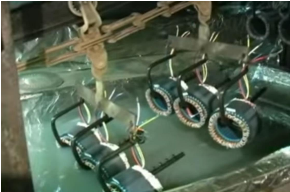
Рисунок 1.4 – Занурення статора АД у ванну з лаком
