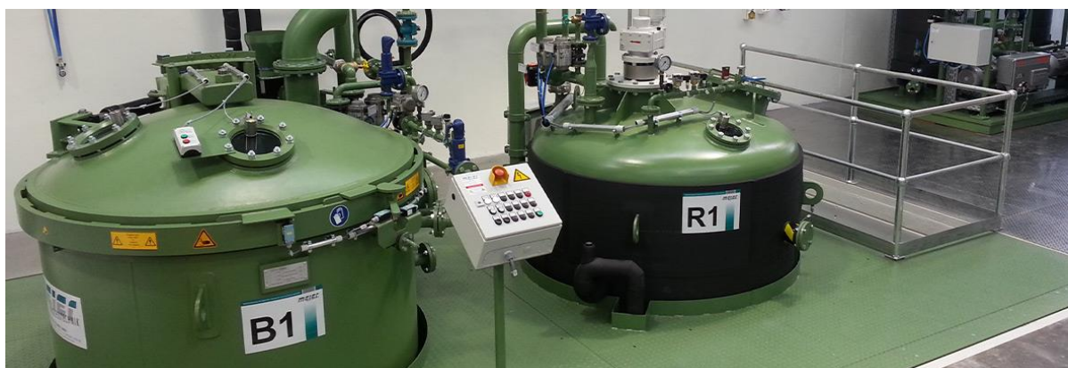
Рисунок 1.6 – Просочувальна установка компанії Meier Prozesstechnik
