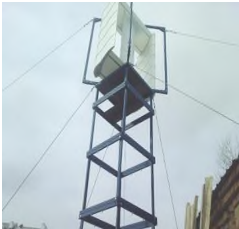
Серійна однарусна роторна установка потужністю 1 кВт. на секційній щоглі
