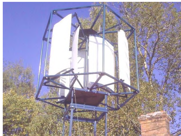
Серійна однарусна роторна установка потужністю 1 кВт. на секційній щоглі
