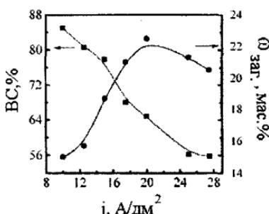
Рисунок. Залежність ВС і загального вмісту вольфраму та молібдену ( $\omega_{\text{заг.}}$ ) у сплаві Co–Mo–W від густини струму (час імпульсу 2 мс, час паузи 10 мс).
