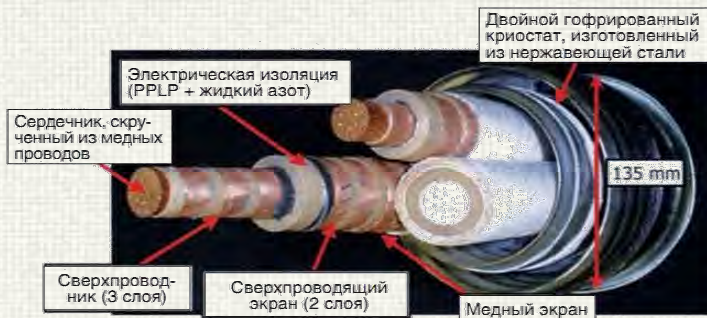
Рис. 7. Секция трехфазного кабеля, изготовленного компанией Sumitomo Electric Industries с использованием провода 2G HTS компании SuperPower
