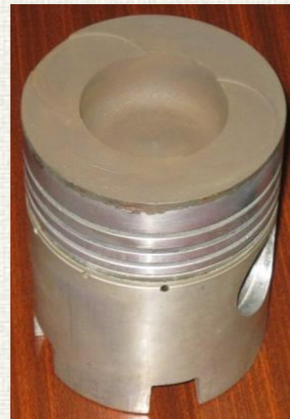
Каталітична система \text{AL25}|\text{Al}_2\text{O}_3 \cdot \text{CoO}_x на поверхні поршня
