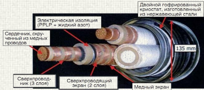
Рис. 7. Секция трехфазного кабеля, изготовленного компанией Sumitomo Electric Industries с использованием провода 2G HTS компании SuperPower
