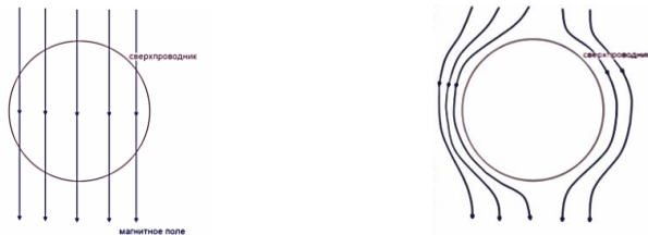
Рис.2 Сверхпроводник при комнатной температуре и при температуре ниже критической в магнитном поле.
