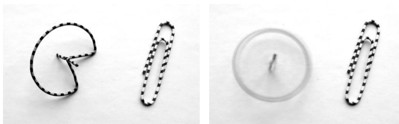
Рис. 1. Волчок Сакаи, согнутый из скрепки размера 50 мм. Слева: в покое на горизонтальной плоскости, справа: во вращении
