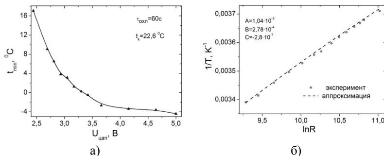
Рис.4. а) Зависимость температуры элемента Пельтье от управляющего напряжения  $U_{\text{цап}}$ ; б) Зависимость  $T^{-1} = f(\ln R)$ .
