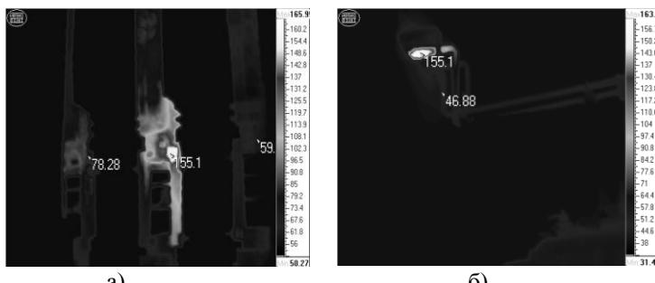
Рис. 2 – Термограмми комутаційних елементів: а) шинний розъєдинитель PBP 2000/10; б) шини низького напруження.
