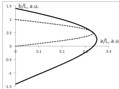
**Рис. 5.** Диапазоны параметров, при которых мости Архимеда устойчивы (сплошная линия для не нагруженного, пунктир для нагруженного).
