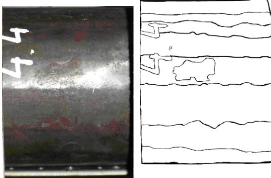
Рис.1-Фото объекта (а),Результат оброботки зображення оператором Робертса після фільтрації (б)
