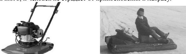
**Рис.2.** Повседневная техника на воздушной подушке: газонокосилка и снегокат.
