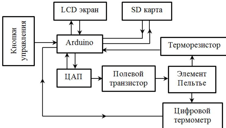
Рис. 2. Функциональная схема установки.
