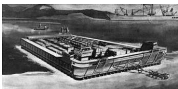
**Рис.8.** Платформа на воздушной подушке для рейдовой разгрузки.
