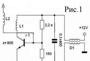
Цим контуром є котушка індуктивності. Вона резонує на частоті, яка визначається кількістю витків і міжвитковими ємностями. Діапазон частот генерації від 3 до 100 Мгц.
