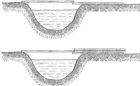
Рис. 3. Простейшие мости из двух и четырех одинаковых досок.
