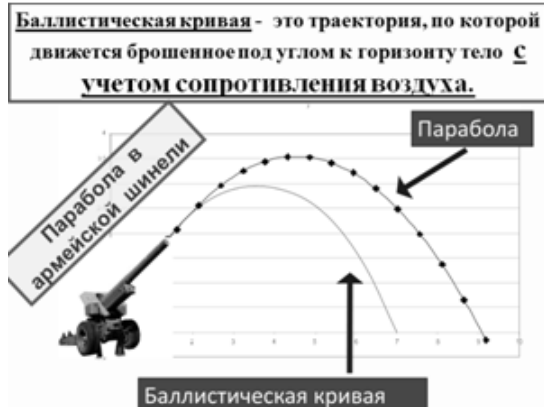
Рис.5. Ідеальна і реальна траєкторії польоту снаряда.
