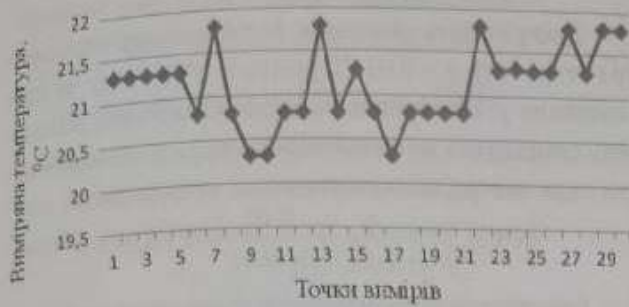
Рис. 5. Результати спостережень за зміною температури столу в зоні «вистрілювання» олівців у пенал за допомогою датчика температури TMP36
