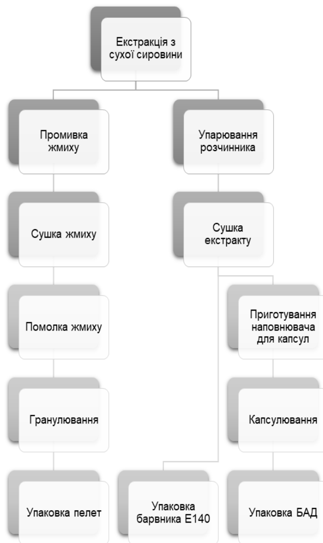
Рис. 4 – Структурна блок-схема виробництва хлорофілу та паливних пелет
