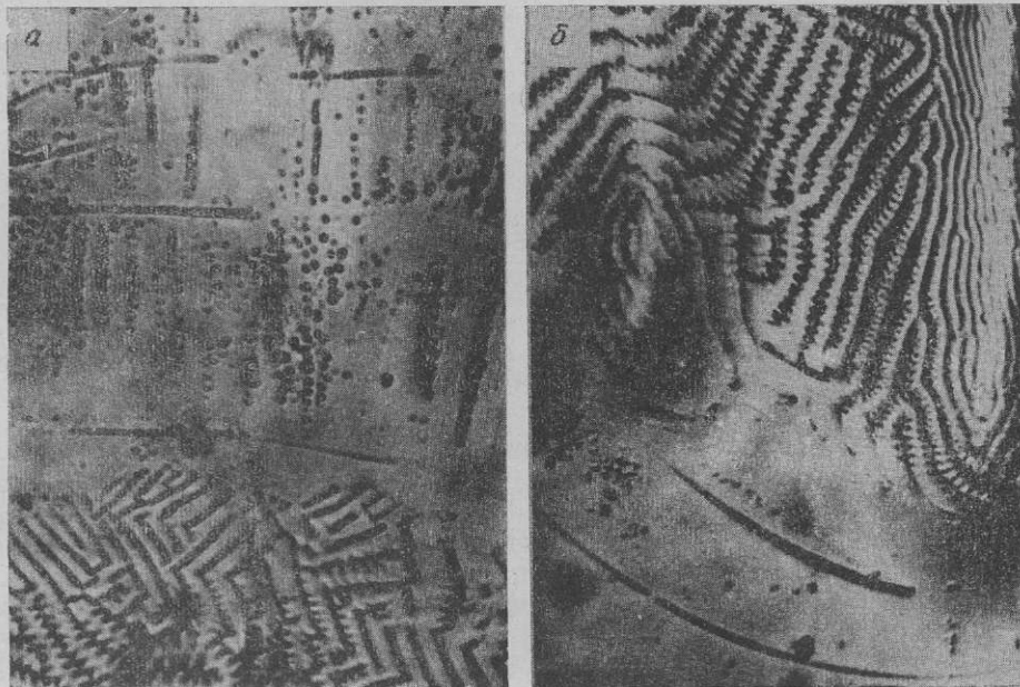
Рис. 4. Порошковые фигуры на блестящей поверхности лент с локализацией ПДС на гладких (а) и шероховатых (б) участках.
