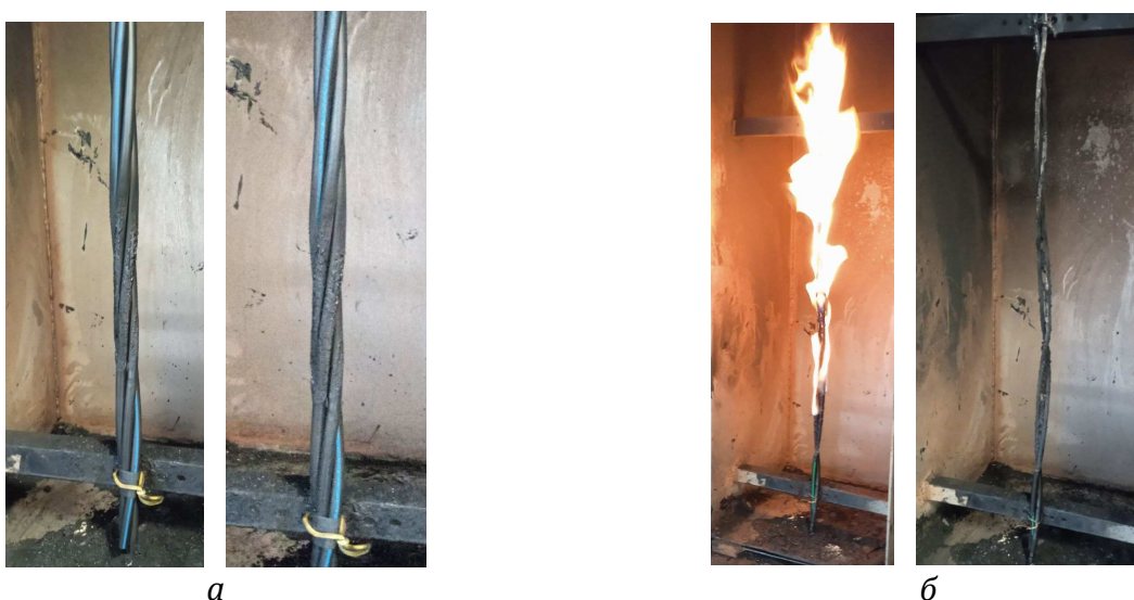
Рис. 1 – Результати випробування проводу марки AsXSn 4×70: а – провід пройшов випробування; б – провід не пройшов випробування
