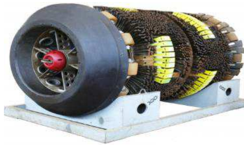
Рис.3. Ультразвуковий дефектоскоп ДЭМАБ-1400 для контролю труб великого діаметру при діагностиці з внутрішньої сторони. Надійно виявляє стрес-корозійні пошкодження [3]
