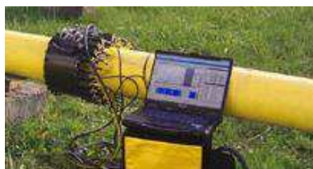
Рис.2. Дефектоскоп для виявлення дефектів в трубі на відстанях до \pm 180 м при зовнішньому тестуванні низькочастотними ультразвуковими хвилями та схема його роботи [3] луна методом
