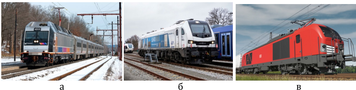
Рис. 1 – Локомотиви з дворезимним живленням: а – локомотив ALP-45DP; б – локомотив EURO9000; в – локомотив Vectron Dual Mode
