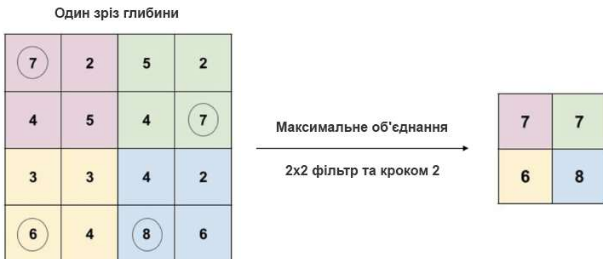
Рис. 2 – Пулінг об'єднання шарів
