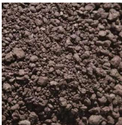
Рис. 1 – Зовнішній вигляд нікель-цинкового фериту (N3Z7) синтезованого при температурі 1000 °С при ізотермічній витримці 2 години
