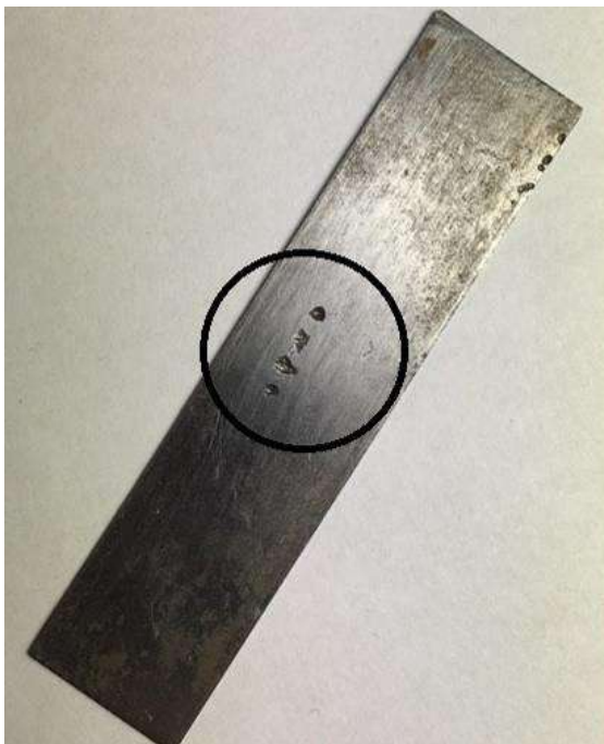
Рис. 1 – Металева стрічка з ерозійним дефектом: a – фото реального зразка; б – комп'ютерна модель з радіусним дефектом
