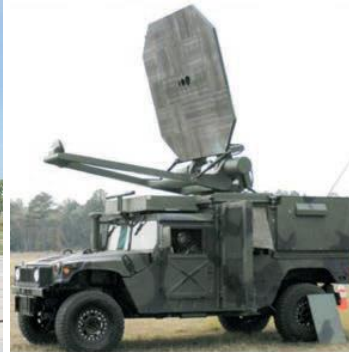
Потужні джерела направленої дії ультразвукової частоти (95 ГГц) на шасі джипу Hummer та БТР Stryker (США)
