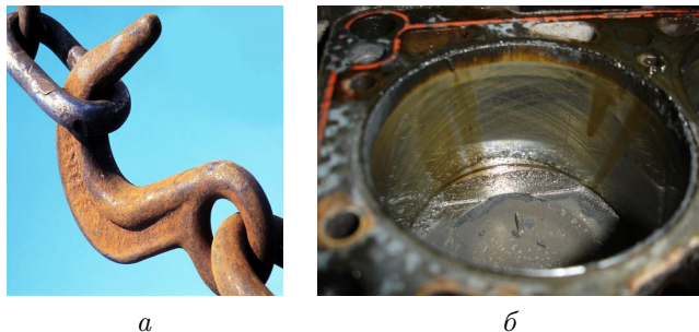
Рисунок 13.2 – Види хімічної корозії: a – газова корозія, б – корозія у неелектролітах
