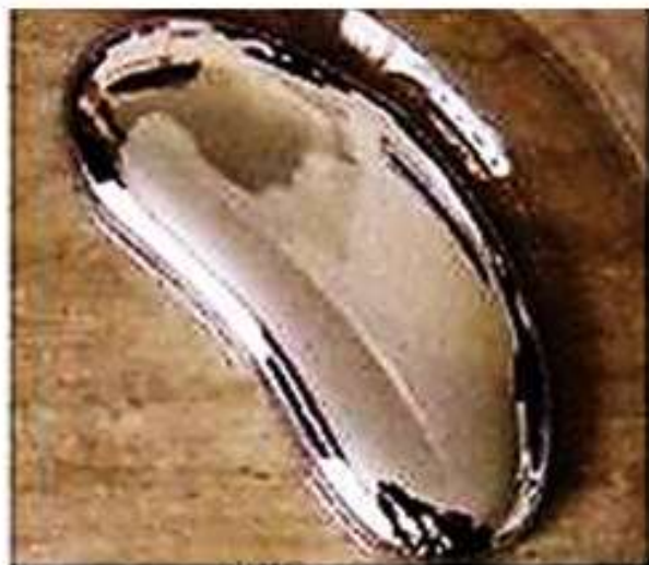
Ртуть – найлегкоплавкіший метал ( T_{\text{пл.}} = -38,9^{\circ}\text{C} )
