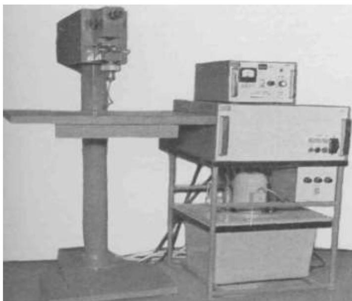
Рисунок 3.8 – Лазерная установка для сверления отверстий
