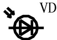
Рисунок 4.13 – Условное графическое обозначение фотодиода.
