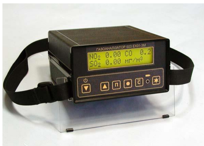
Рисунок 1 – Газоаналітичні автоматичні комплекси контролю за забрудненням атмосферного повітря: а – «ГАЗ – Атмосфера»; б – АСЕМА; в – переносний автотрасовий газоаналізатор 603 ЭХ01-3М
