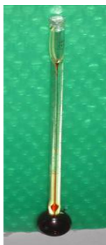
Рисунок 7 – Зовнішній вигляд кататермометра з кульовим резервуаром
