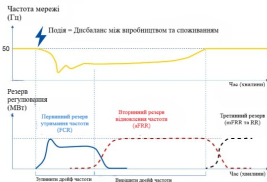
Рис.1 Підтримка частоти енергетичної мережі за рахунок акумуляторної системи зберігання енергії BESS
