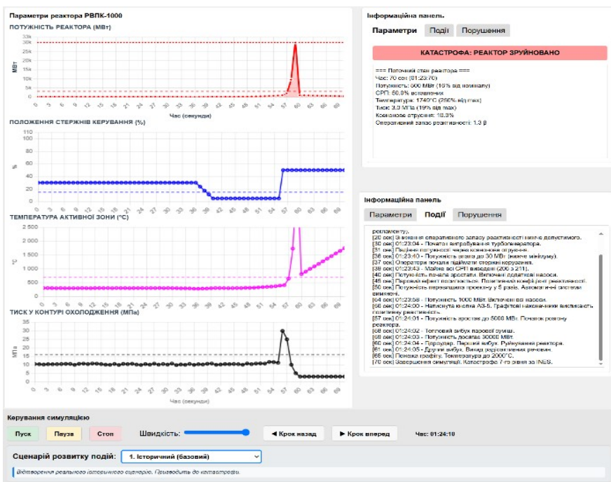
Рис. 1. Загальний вигляд інтерактивного симулятора-тренажера з візуальним відображенням динаміки зміни ключових параметрів ядерного реактора ЧАЕС
